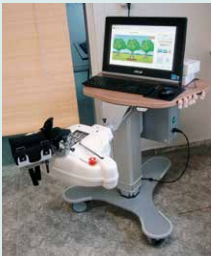
Robotický systém pro funkční terapii horní končetiny s motivační zpětnou vazbou pro cvičení ruky a jednotlivých prstů (AMADEO)
